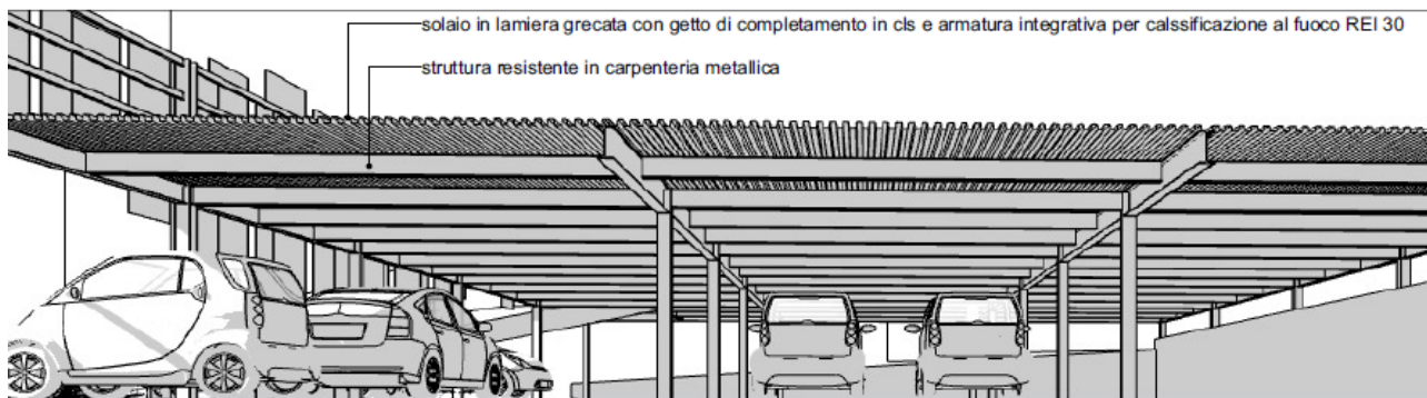
sezione prospettica su carpenteria verticale e orizzontale e solaio con lamiera grecata
